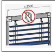
Construction de stores autoporteuse
