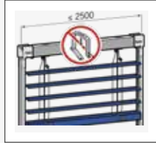
Construction de stores autoporteuse
