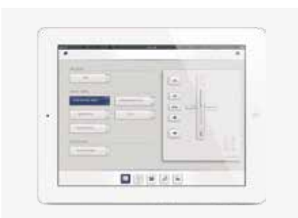
Commande KNX / gBUS par iPad
