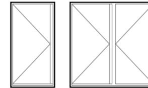
Porte-fenêtre 1 et 2 vantaux avec seuil et montant serrure
