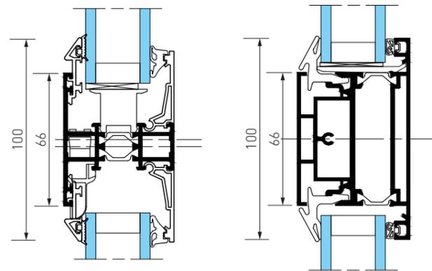
1 Traverse fixe de 66 mm avec drainage caché
